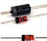
Ajoutez D1, D2 et D3. Les diodes sont placées verticalement, cathode vers le haut. Pliez la patte cathode (repérée par un anneau sur le corps de la diode).
