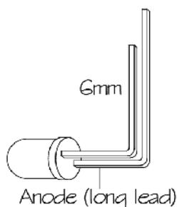
Pliez les pattes de D5 à 6mm du corps de la LED en prenant soin à la position de l'anode (patte la plus longue). Insérez depuis l'arrière du circuit imprimé et soudez de telle sorte que la LED tangente la surface du CI.
