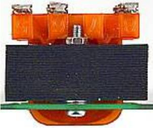
Avec ce transformateur, la découpe du circuit imprimé ne doit PAS être agrandie.
