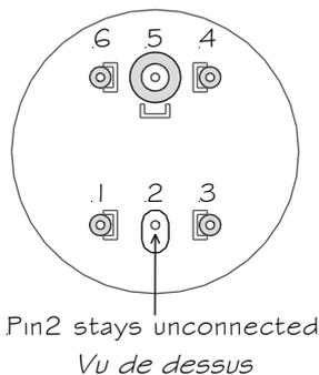
Les trous dans le circuit imprimé sont identifiés par des crochets rectangulaires.
