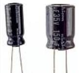
Insérez C51 à fond puis inclinez le jusqu'à ce qu'il repose à plat sur le CI.
