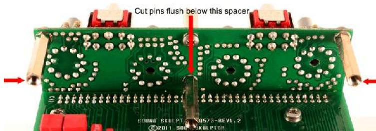
**34. Adaptateurs d'axe 6/4mm pour les potentiomètres.**
