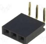
Insérez le connecteur femelle 3 broches dans le deuxième rang de trous (cerclés en rouge). Il est possible d'ajouter une goutte de super-glue entre le connecteur et le CI pour améliorer la rigidité. Puis soudez. Répétez l'opération pour le deuxième CI.
