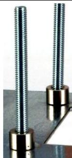
Insérez 4 vis à tête fraisée M3x35 mm dans la plaque latérale. Sur chaque vis insérez une entretoise de 4mm. Insérez le transfo et fixez le à l'aide de 4 écrous autobloquants. Serrez sans écraser le cadre du transfo.
