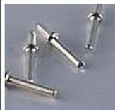
Insérez et soudez les 16 picots de 10mm (15 sur le connecteur + 1 GND). Les picots sont insérés depuis la face composants, le côté de section carrée en avant. Ils peuvent nécessiter une certaine pression pour être bien enfoncés.
