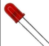
Pliez les pattes de D3 à 5mm du corps, en faisant attention à la position de l'anode. Le bord de la LED doit appuyer sur le CI.
